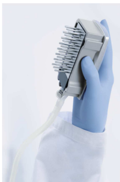
Figur 4. Illustration af vakuumværktøjet, der er løftet til over en lodret vinkel på 90°.
