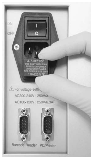
Auswahl der korrekten Sicherung bei einer Versorgungsspannung von 100–120 V.
