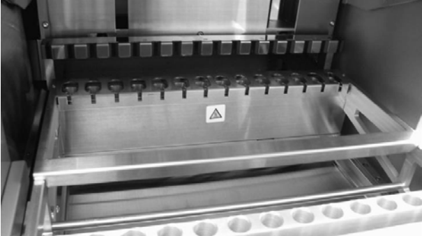
Symbol für Überhitzungsgefahr auf dem Heizsystem.
