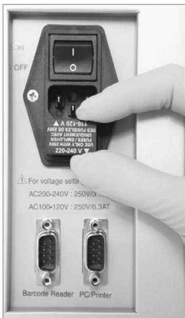
Auswahl der korrekten Sicherung bei einer Versorgungsspannung von 200–240 V.
