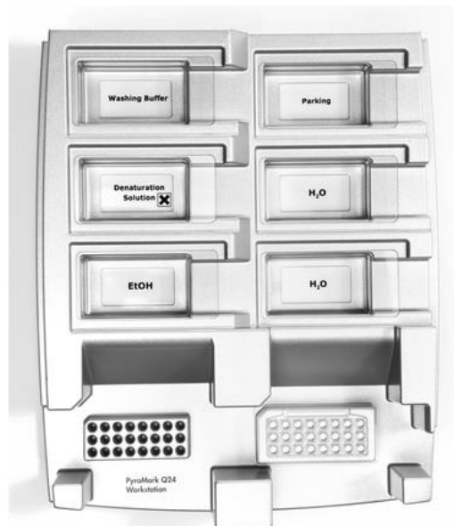
Obrázek 3. Uložení PCR destičky (nebo stripů) a destičky PyroMark Q24 do vakuové stanice.
