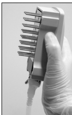
Rysunek 3. Narzędzie próżniowe uniesione celem odessania całego płynu z filtrów.
