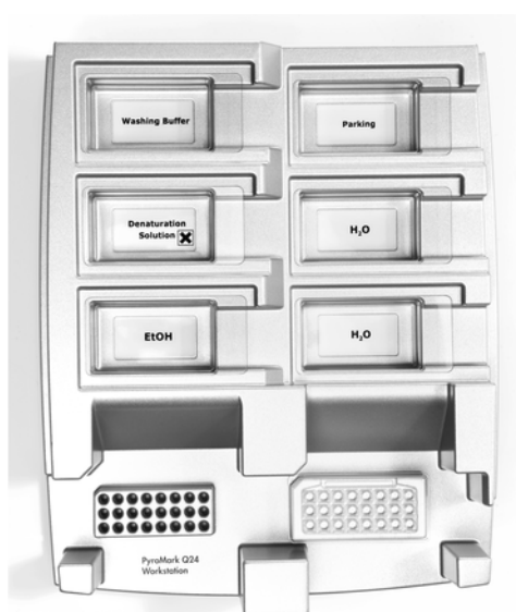
Rysunek 2. Umieszczanie płytki PCR PyroMark Q24 (lub pasków) na stacji próżniowej.
