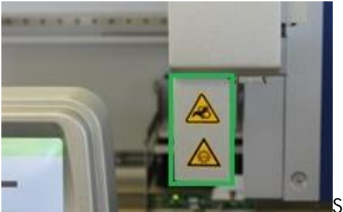
* Poloha štítiku s varovaním o nebezpečí pohmoždění a štítiku varování o UV světle (SP/AS).
