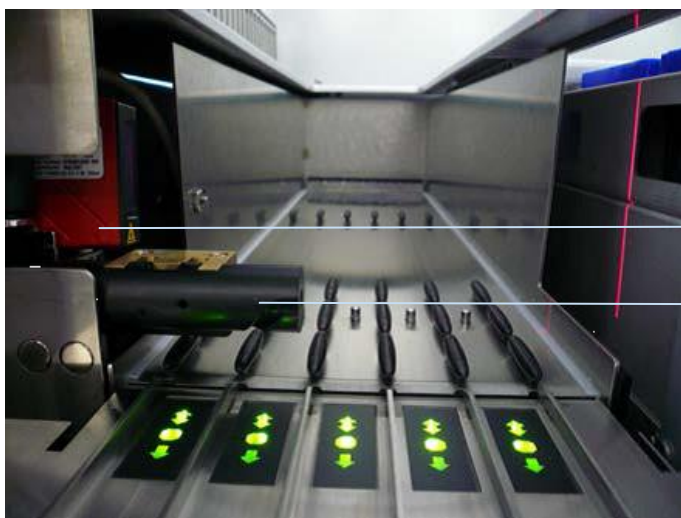
Polohy čtečky čárových kódů a distanční vložky.
