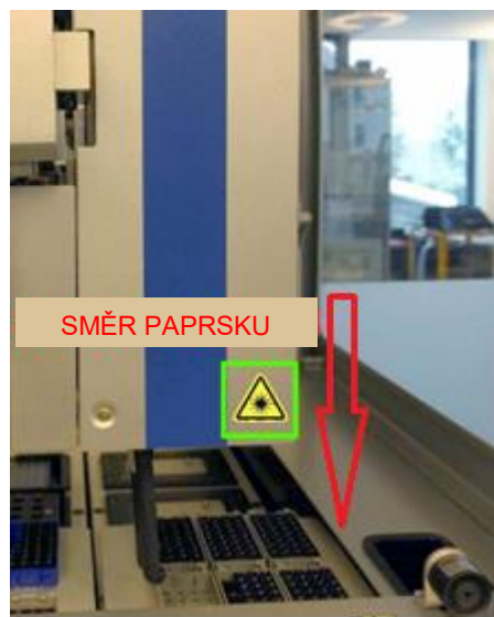
† Pozice 2 pro štítek s varovaním o laserovém světle (AS).
