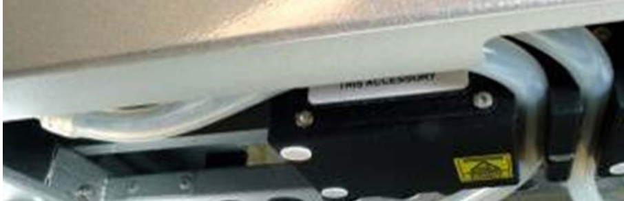
In der Lücke zwischen der hinteren Blende und dem Quetschventil sichtbare Schläuche
