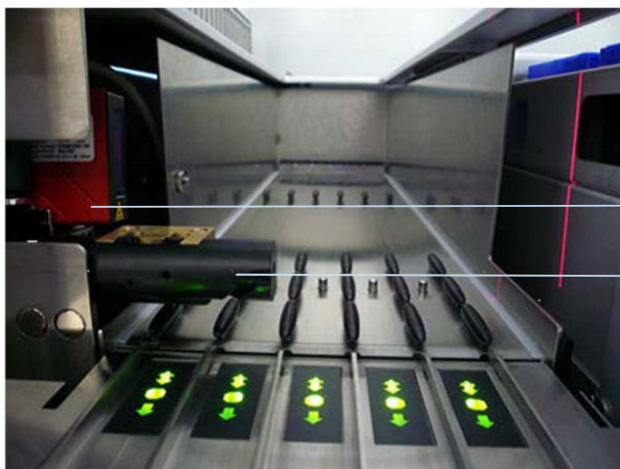
Emplacements du lecteur de code-barres et du séparateur.
