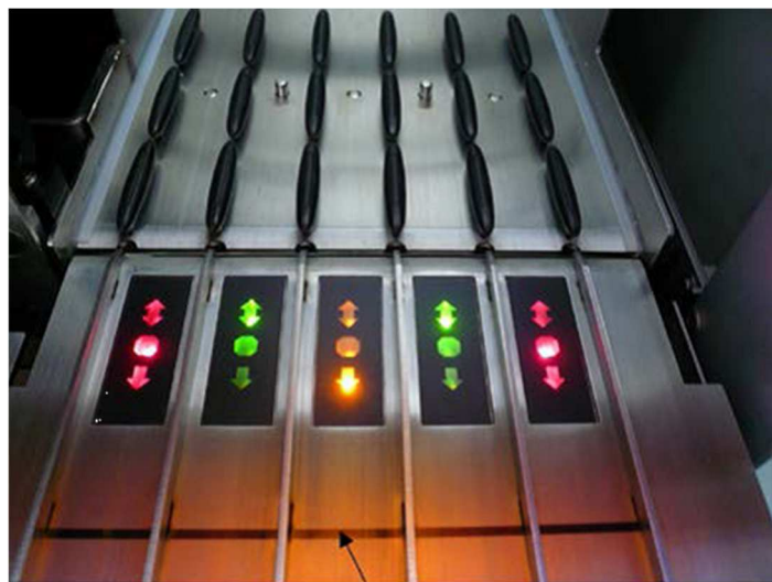
Stop line Slot 1-4 Slot A Exemples d'éclairage DEL identifiant l'état des slots.
