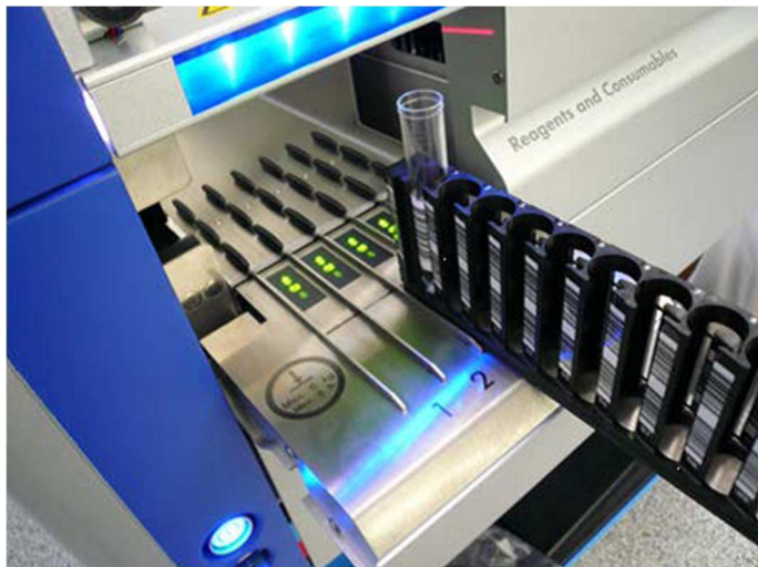
Insertion d'un porte-tube dans le slot adapté.
