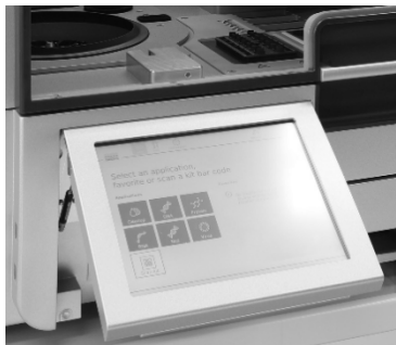
Afbeelding 19. Uitgetrokken aanraakscherm van QIAcube Connect MDx
