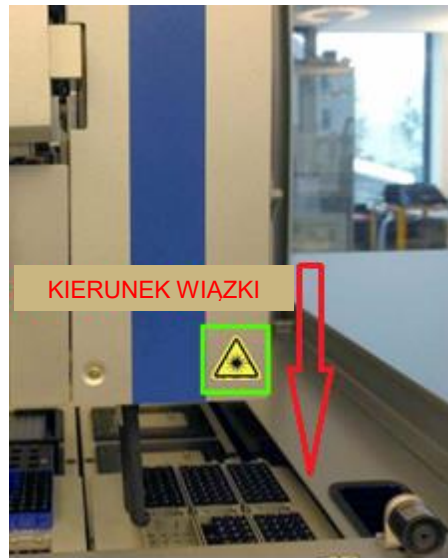
‡ Umieszczenie 2 etykiety ostrzegającej o świetle laserowym (AS).
