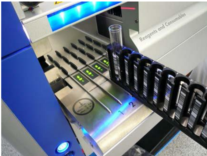
Wsuvanie nośnika probówek w odpowiednie gniazdo.
