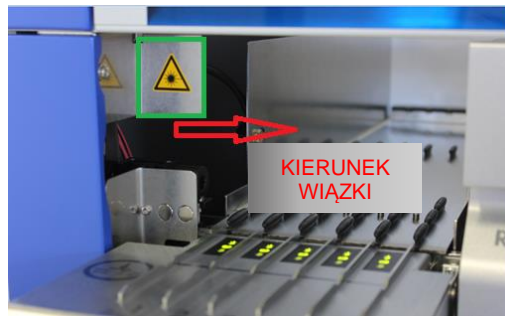
† Umieszczenie 1 etykiety ostrzegającej o świetle laserowym.
