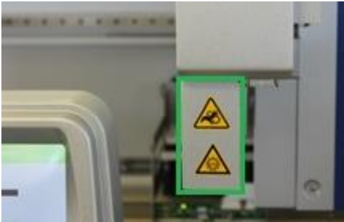
* Umieszczenie etykiety ostrzegającej o zagrożeniu przygnieciem i etykiety ostrzegającej o świetle UV (SP/AS).
