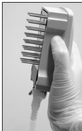
Figur 3. Illustrasjon av vakuumverktøyet som er løftet mer enn 90° vertikalt.
