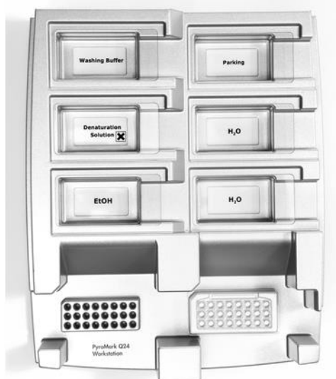
Figur 2. Plassering av PCR-plate (eller remser) og PyroMark Q24-plate på vakuumarbeidsstasjonen.
