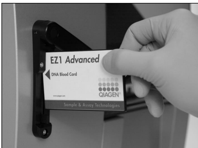
Figura 9. Facilidade de configuração do protocolo utilizando os cartões EZ1 DSP. Inserção de um cartão EZ1, contendo um protocolo, no instrumento EZ1.
