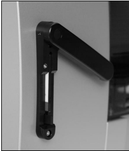
Figura 10. Cartão EZ1 totalmente inserido na ranhura do cartão EZ1.
