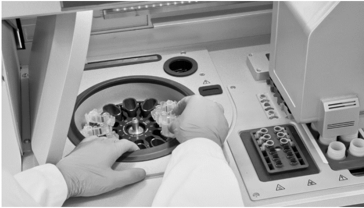
圖 25：裝載 QIAcube 儀器的離心機。 將組裝好的轉子轉接器裝載至離心筒內（顯示 QIAcube Connect MDx 做為範例）。
