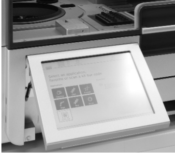
圖 19：QIAcube Connect MDx 的拉出觸控式螢幕
