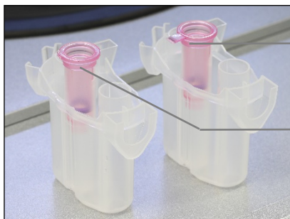
Jämförelse av korrekt och felaktigt borttagna kolonnlock
