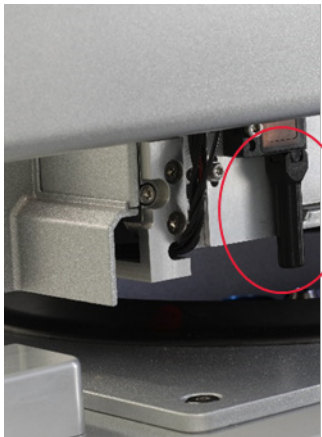
Ultraljudssensorns svarta strålkollimator (se röd cirkel)
