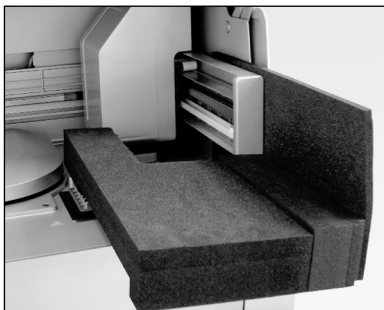
Skumskyddet har placerats mellan centrifugen och robotarmen
