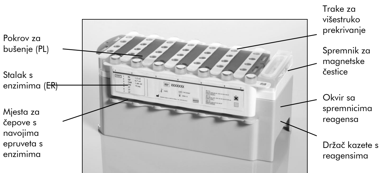
Slika 2. QIASymphony kazeta s reagensima (RC). Kazeta s reagensima (RC) reagense potrebne za izvođenje postupka.
