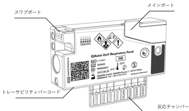
図 3. QIAstat-Dx assay cartridge の機能。
