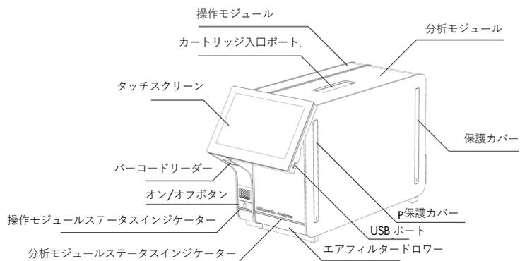
図 1. QIAstat-Dx Analyzer 1.0 の前面図。操作モジュールは左に、分析モジュールは右にあります。
