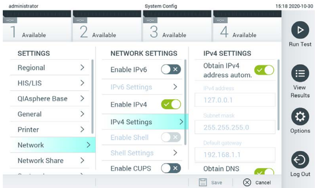
Figura 68. Configurarea setărilor de rețea.
