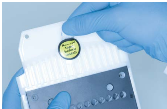
6 pav. „QIAxcel Gel Cartridge“ paruošimas.
