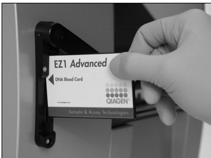
Figure 9. Configuration facile des protocoles avec les cartes EZ1 DSP. Insertion d'une carte EZ1, contenant le protocole, dans l'appareil EZ1.
