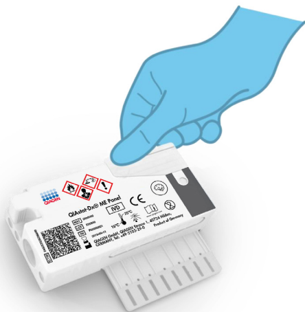
Obrázek 9. Zavření víčka v hlavním portu.
