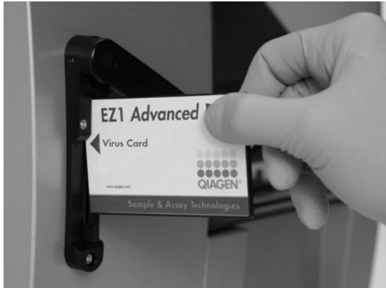
Фигура 1. Опростено настройване на протокола с EZ1 DSP карта. Поставяне на EZ1 картата, препрограмирана с протокола, в EZ1 инструмента.
