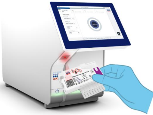
Afbeelding 13. Streepjescode van de QIAstat-Dx Gastrointestinal Panel Cartridge scannen.
