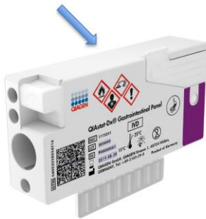
Afbeelding 5. Plaatsing van monsterinformatie op de QIAstat-Dx Gastrointestinal Panel Cartridge.
