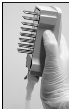
Kuva 3. Ylös ja taaksepäin yli 90° pystysuunnassa nostettu alipainetyökalu.
