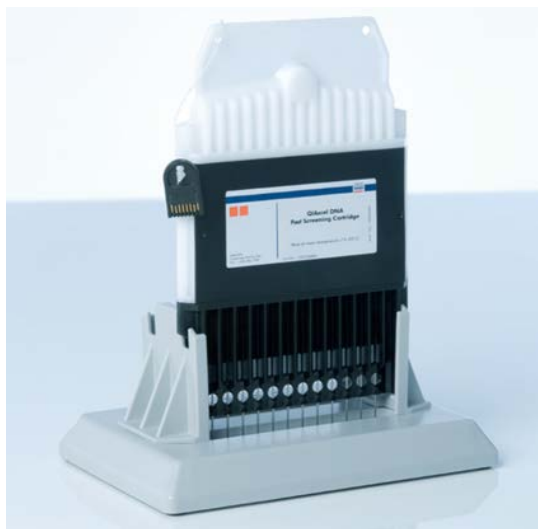
Slika 7. Inkubacija na stojalu QX Cartridge Stand.
