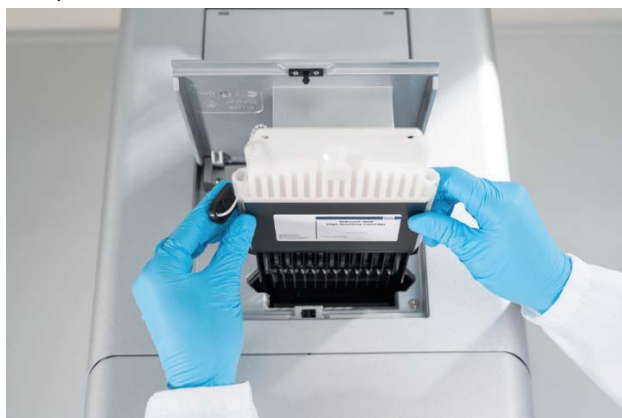
Slika 9. Namestitev kartuše QIAxcel Gel Cartridge.
