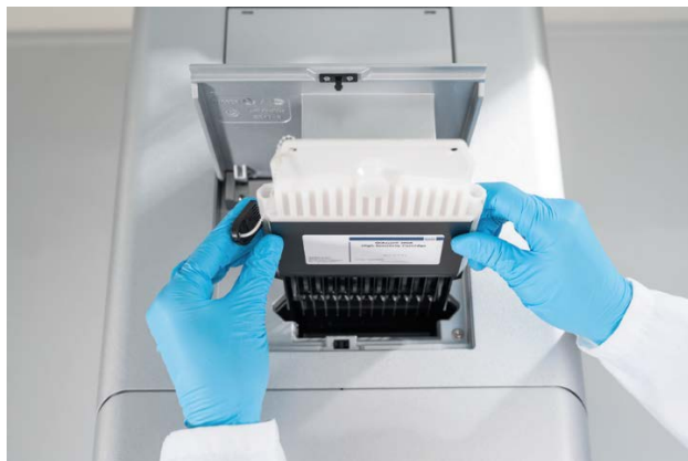
Figur 9. Installation av QIAxcel Gel Cartridge.
