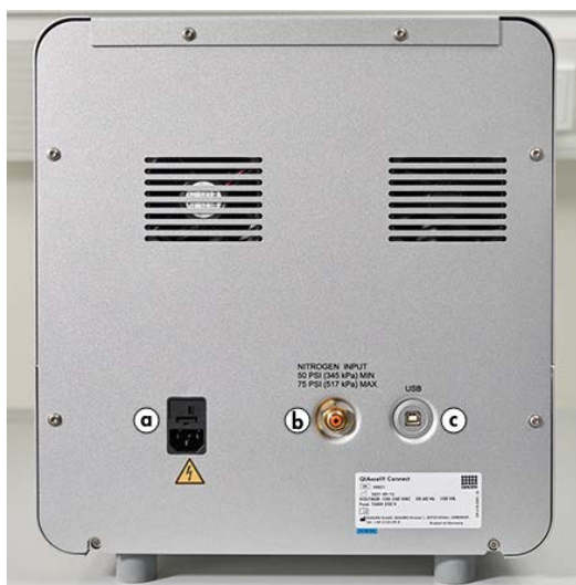
Figur 5. Strömanslutning (a), extern N2 (b) och USB-port (c).
