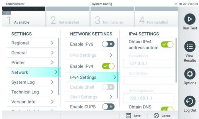
Figura 62. Configuración de los ajustes de red.
