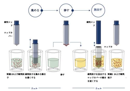
図 1QIAsymphony SP原理の模式図QIAsymphony SPは以下のような磁気粒子を含むサンプルを処理しま す。ロッドカバーで保護された磁気ロッドがサンプルの入ったウェルに入り、磁気粒子を引きつけま す。磁気ロッドカバーは他のウェルの上にあり、磁気粒子が放出されます。このステップがサンプル 処理の間、数回繰り返されます。QIAsymphony SP は 24本の磁気ロッドを含む磁気ヘッドを使用する ので 24までのサンプルを同時に処理できます。
