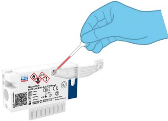
Abbildung 21. Überführen der Probe in die Hauptöffnung der QIAstat-Dx SARS-CoV-2/Flu A/B/RSV Panel Cartridge.
