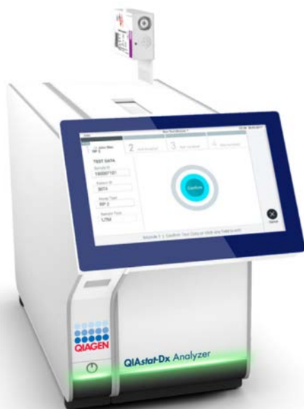
Obrázek 15. Vložení kazety QIAstat-Dx Gastrointestinal Panel Cartridge do přístroje QIAstat-Dx Analyzer 1.0.
