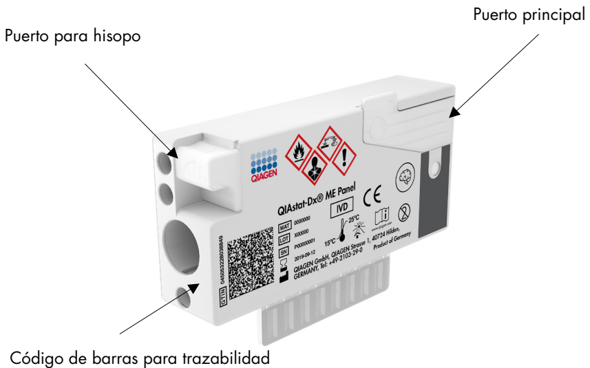
Figura 1. Diseño del QIAstat-Dx ME Panel Cartridge y sus características.
