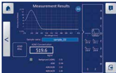
図3. 従来法およびスマート解析プロトコール QIAXpertは新たな解析ニーズに合致する柔軟性を有する。従来の吸光度解析と同様にスペクトラルコンテンツプロファイリングによるスマート解析は、サンプルに含まれる目的分子を特異的に見出すことができる。
