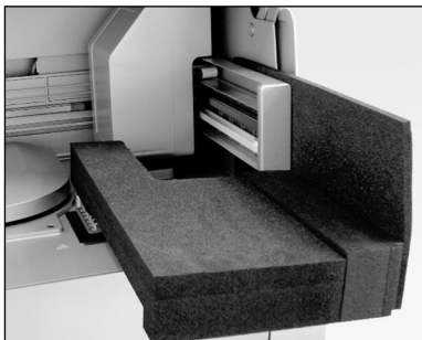
Skumbeskyttelse satt inn mellom sentrifugen og robotarmen
