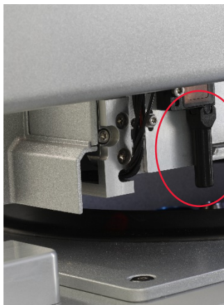
Svart strålekollimator (se rød sirkel) på ultralydsensoren
