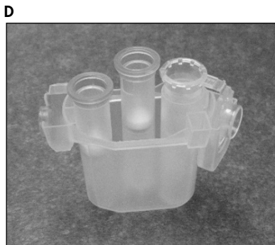
Lokk til 1,5 ml mikrosentrifugerør er ikke skjøvet ned i sporet
