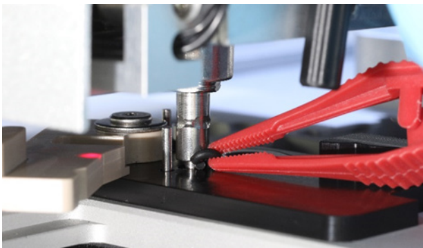
Åpne den grå spaken, og fjern O-ringen med pinsetten
