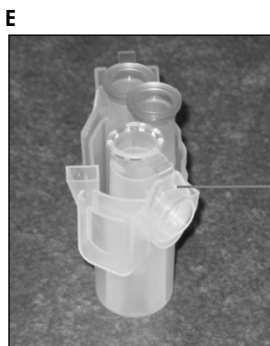
Lokk til 1,5 ml mikrosentrifugerør er i feil spor i rotoradapteren
