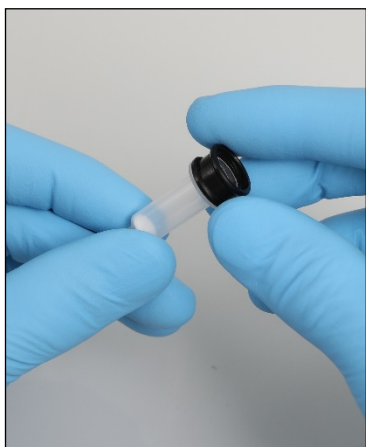
Montere en adapterring til spinnkolonne.
