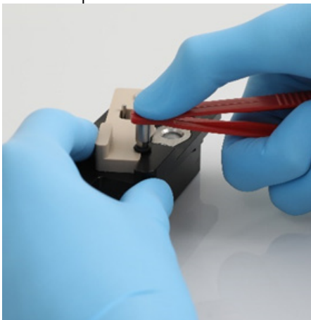
Trykk pinnen ned med bakkdelen av pinsetten
