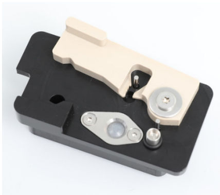
O-ringverktøy med klargjort, ny O-ring
