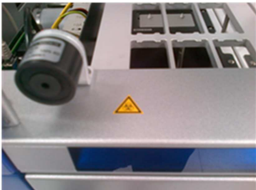
† Расположение этикетки, предупреждающей о биологической опасности, на рабочем столе, рядом с магнитным затвором колпака (AS).
