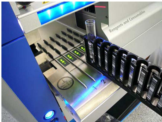
Вставка держателя пробирок в подходящий слот.
