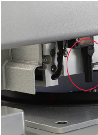
Ultraäänianturin musta säteen rajain (katso punainen ympyrä)
