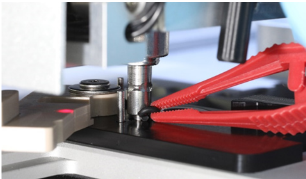
Avaa harmaa vipu ja poista O-rengas pinsettien avulla.
