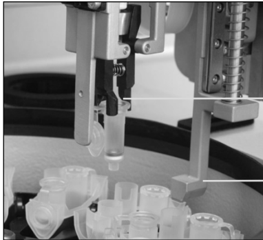
Robottitarrain automatisoi pyöritysputken käsittelyn
