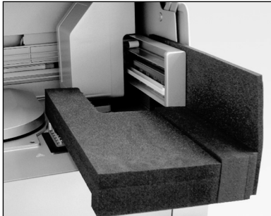
Vaahтомуovisuojaus asetettuna sentrifugin ja robottivarren väliin
