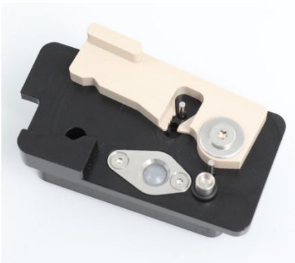
O-rengastyökalu ja valmistettu uusi O-renkas
