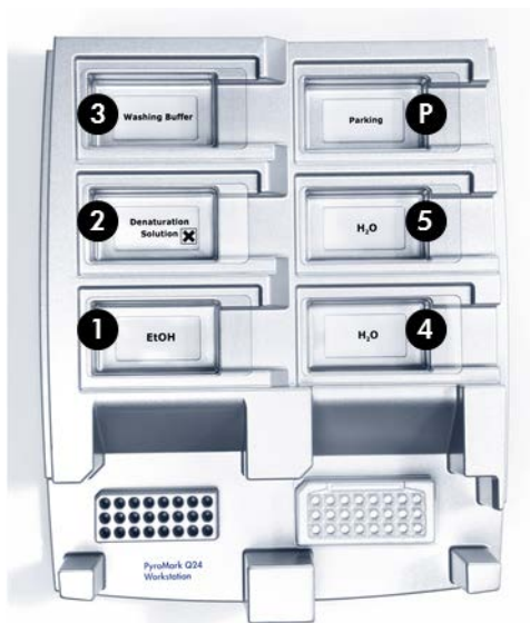
3. ábra: A PCR-lemez és a PyroMark Q24 Plate elhelyezése a vákuum munkaállomáson.
