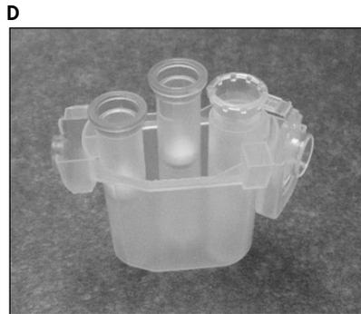
**Adaptor rotor yang dimuat secara salah.** **C** Adaptor rotor dimuat secara salah dengan tabung mikrosentrifugasi 1,5 ml. Penutup tabung tidak ditekan seluruhnya hingga ke dasar slot adaptor rotor dan dapat rusak selama sentrifugasi (bandingkan dengan bagian **A** pada gambar di atas); **D** Adaptor rotor yang dimuat secara salah tampak dari samping (bandingkan dengan bagian **B** pada gambar di atas).
