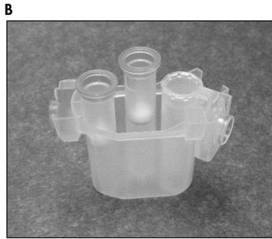
**Adaptor rotor yang dimuat dengan benar.** **A** Adaptor rotor dimuat dengan benar, dan penutup tabung mikrosentrifugasi 1,5 ml berada dalam posisi yang benar; **B** Adaptor rotor yang dimuat dengan benar tampak dari samping.
