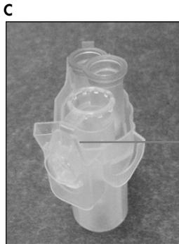
Penutup tabung mikrosentrifugasi 1,5 ml tidak ditekan masuk ke dalam slot
