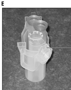
Penutup tabung mikrosentrifugasi 1,5 ml berada di slot adaptor rotor yang salah
