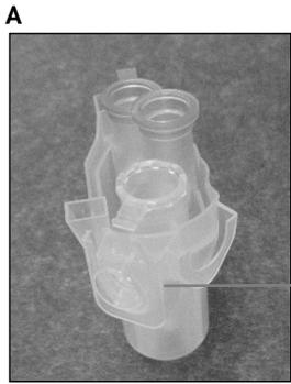
Penutup tabung mikrosentrifugasi 1,5 ml berada dalam posisi yang benar
