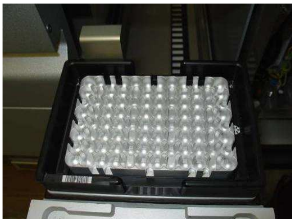
Adattatore collocato sul telaio di trasferimento nello slot 1 del cassetto "Eluati" (Eluati).
