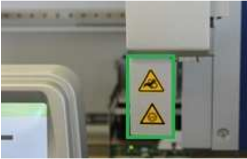
† Posizione dell'etichetta di avvertenza pericolo di schiacciamento e dell'etichetta di avvertenza luce UV (SP/AS).
