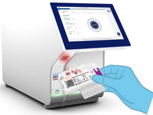
Figura 13. Escaneo del código de barras del QIAstat-Dx Gastrointestinal Panel Cartridge.
