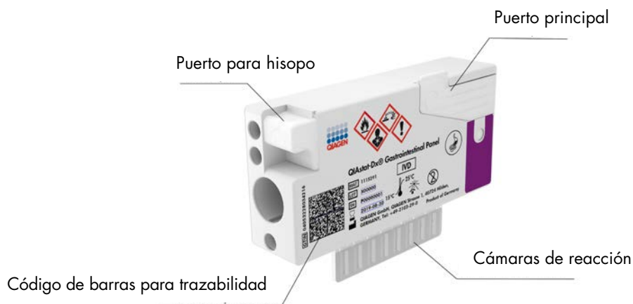
Figura 1. Diseño del QIAstat-Dx Gastrointestinal Panel Cartridge y sus características.
