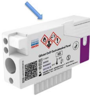
Figura 5. Colocación de los datos de la muestra en la parte superior del QIAstat-Dx Gastrointestinal Panel Cartridge.
