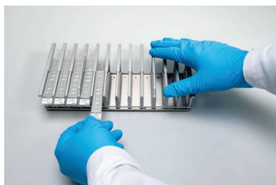
図 1. 試薬カートリッジを使用した簡便なワークテーブルのセットアップ。 (A) 密封した充填済み試薬カートリッジ。充填レベルは、試薬カートリッジのタイプによって異なります。(B) 試薬カートリッジをカートリッジラックにセットします。カートリッジラック自体には、試薬カートリッジをセットする方向を示した矢印のラベルが付いています。
