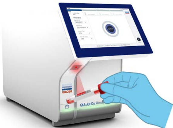
Figur 11. Scanning af prøve-ID-stregkode.
