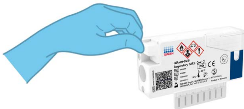
Εικόνα 10. Κλείσιμο του καπακιού δείγματος της θύρας στειλεού.
