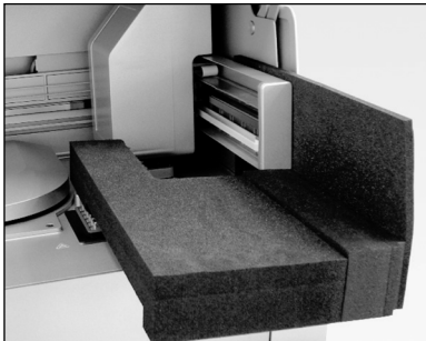
Robotizētās sviras putuplasta aizsargmateriāls.
