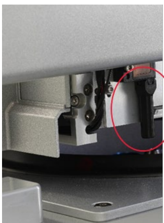
Ultraskaņas sensora melnā staru kūļa kolimators (skatiet sarkanajā aplī)
