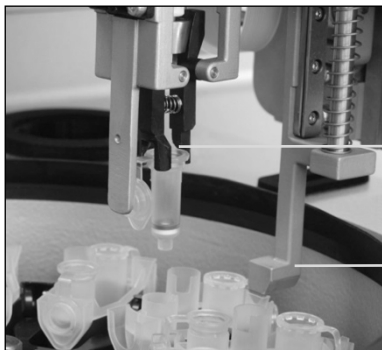
Robotizētā satvērēja nodrošinātā centrifūgas stobriņu automatizētā apstrāde
