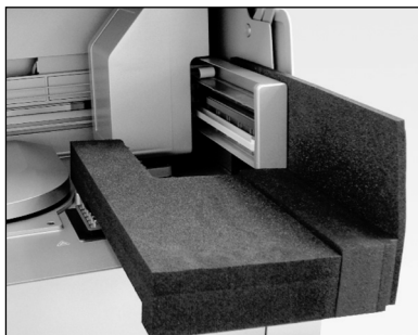
Putuplasta aizsargmateriāls ievietots starp centrifūgu un robotizēto sviru
