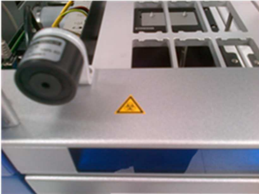
† Position des Biogefährdung-Warnzeichens auf der Arbeitsplattform in der Nähe des Hauben-Magnetverschlusses (AS).
