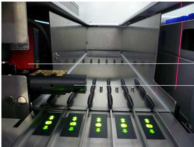
Positionen von Barcode-Reader und Abstandshalter.
