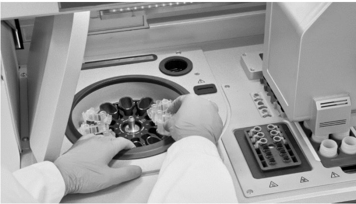
Kuva 25. QIAcube-laitteiden sentrifugin täyttäminen. Aseta kootut roottoriadapterit sentrifugin koteloihin (QIAcube Connect MDx esitetty esimerkkinä).
