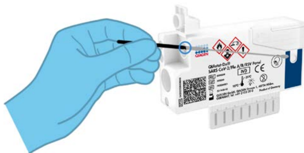
Bild 8. Föra in svabben i QIAstat-Dx SARS-CoV-2/Flu A/B/RSV Panel Cartridge.
