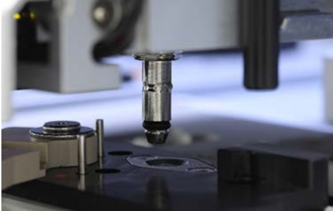
Vérifier si le nouveau joint torique est bien positionné
