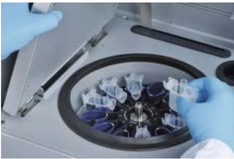
Retrait des adaptateurs de rotor
