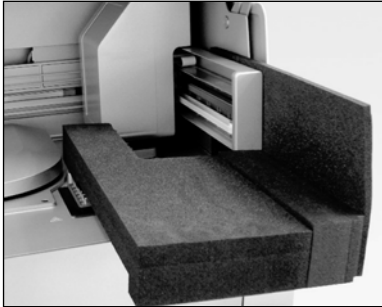
Mousse de protection du bras robot.
