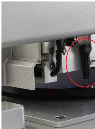
Collimateur d'orientation du faisceau noir (entouré en rouge) du capteur ultrasonore
