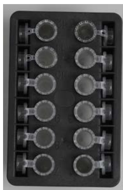
Les bouchons des tubes d'échantillon doivent être correctement placés dans les logements sur le côté du portoir à agitateur
