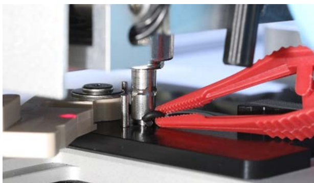
Ouvrir le levier gris et retirer le joint torique à l'aide de la pince
