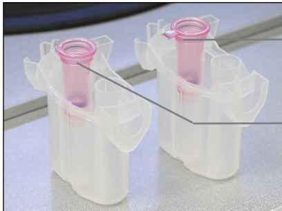
Comparaison entre des bouchons de colonnes bien retirés et mal retirés
