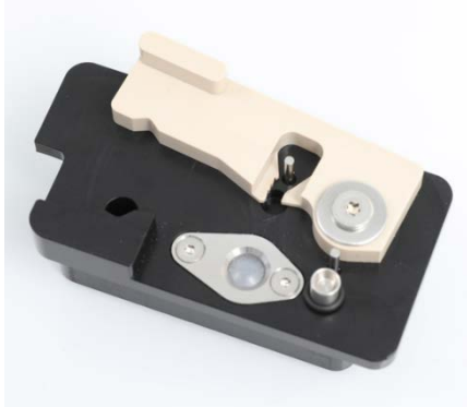
O-Ring Change Tool avec un nouveau joint torique préparé
