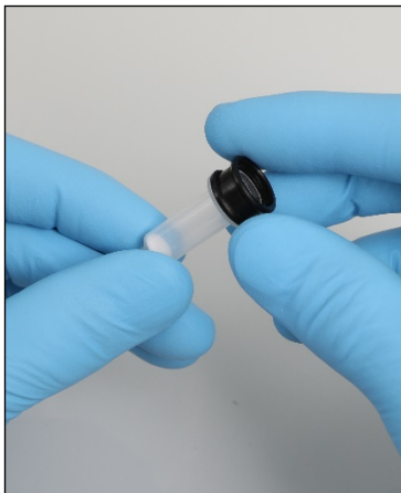
Montage d'un joint d'adaptateur de colonne de centrifugation.
