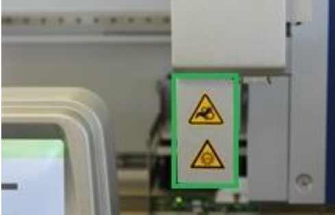
* Položaj naljepnice upozorenja na opasnost od nagnječenja i naljepnice upozorenja na UV svjetlo (SP/AS).
