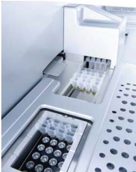
Estação de lise.
