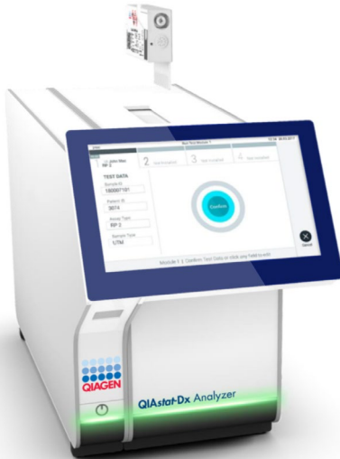
Gambar 14. Memasukkan QIAstat-Dx ME Panel Cartridge ke dalam QIAstat-Dx Analyzer 1.0.
