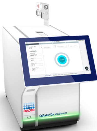
Joonis 14. Kasseti QIAstat-Dx ME Panel Cartridge sisestamine analüsaatorisse QIAstat-Dx Analyzer 1.0
