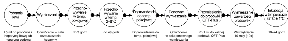
Ryc. 3. Opcja pobierania krwi: Pobranie krwi do probówki z heparyną litową lub heparyną sodową i przechowywanie w temperaturze 2–8°C.
